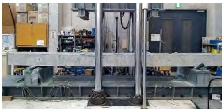
写真-3 CFRPで補強した梁の曲げ載荷試験状況
