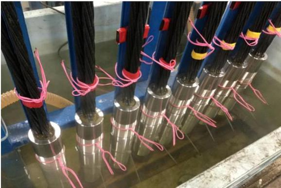
図-3 マルチ配置の CFRP より線に HEM が充填された状況
