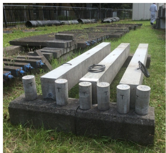
図-5 内陸部への試験体の設置状況
