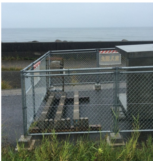
図-4 飛沫帯への試験体の設置状況
