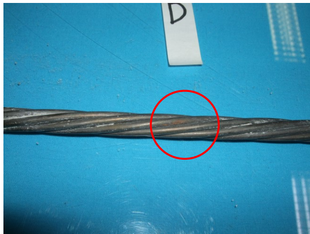
写真-5 鋼材表面のさび(赤マル部分)
