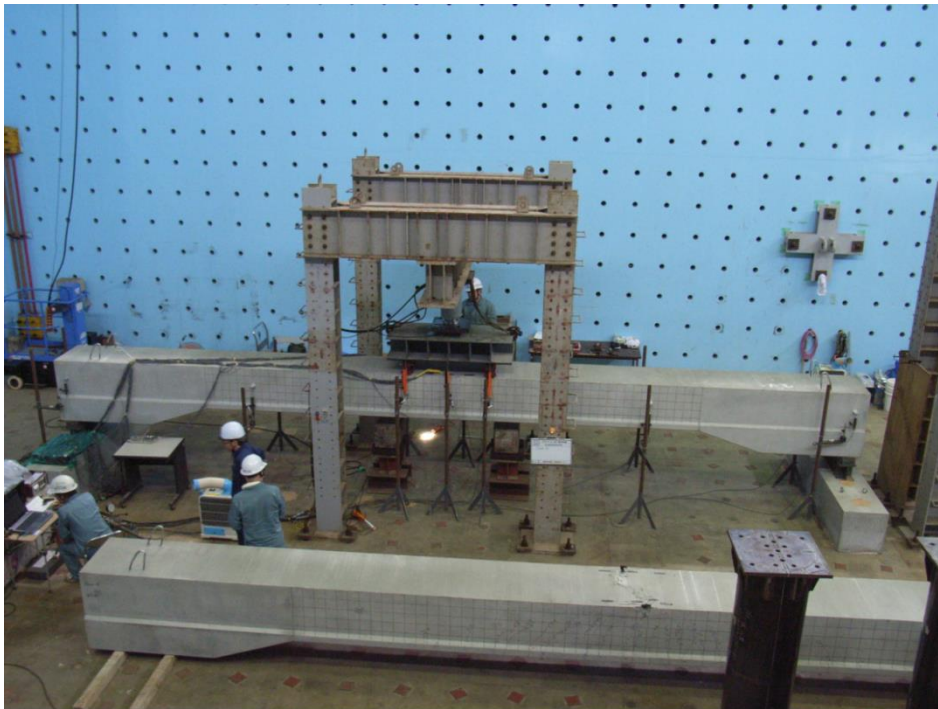
写真-2 曲げ載荷試験状況
